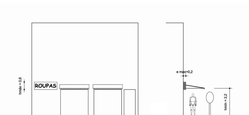
Esquema do uso permitido para letreiros paralelos à fachada, na existência de toldos
